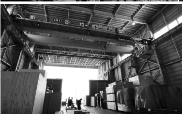
〈左上〉1969年ごろ、横浜市中区新山下にあった当時の基幹倉庫「新山下営業所」。〈右上〉出田町営業所。“全天候型の庇”により大切な製品を風雪から守る。〈左下〉明正の大きな強みの一つ、35トン天井走行クレーン。重量貨物にも対応可能
